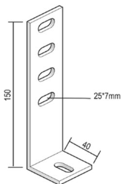
Используется для вертикального монтажа кабельных лотков лестничного типа.
